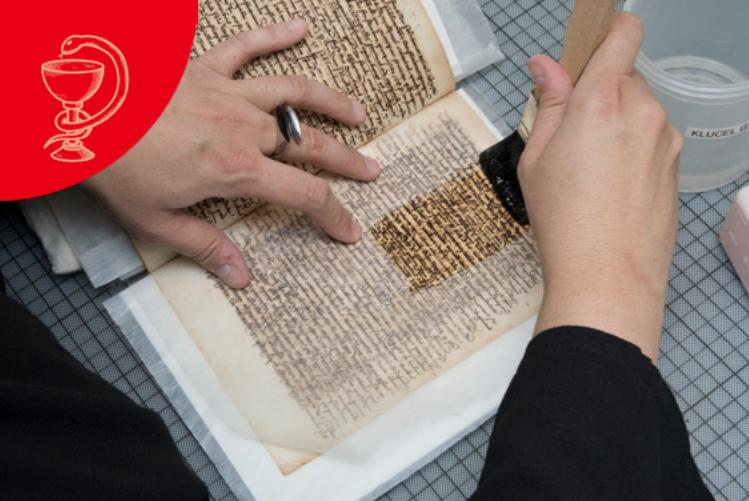
Doublage d'un folio manuscrit du 15<sup>e</sup> siècle perforé par l'encre dite métallogallique. L'encre, composée d'éléments métalliques, déclenche en vieillissant des réactions chimiques qui attaquent la cellulose du papier.
